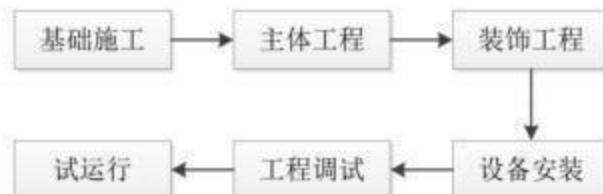
脱色消毒设施站施工工艺流程图
